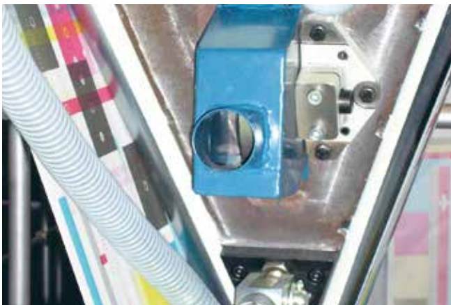
Sugkåpa monterad på skärkniv i tryckpressen
