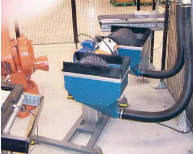
Robotavgrädnad för telekomdelar
